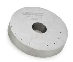
工具钢环形试块是一种标准化测试试块,通常用于湿法磁粉探伤机。该试块由 AISI O1 工具钢加工,经过退火、测试和认证,符合 AS 5282标准要求。工具钢环形试块通常使用直径 1 英寸中心导棒,在边缘加工有不同深度的 12 个通孔,用于验证 半波直流HWDC、全波直流FWDC 和 3 相 全波直流FWDC 磁粉探伤设备的性能。适用于湿法或干法非荧光或荧光磁粉。所需的磁痕数取决于波形和磁化电流大小(有关详细信息,请参阅 AS 5282 或 ASTM E1444)。
